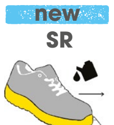
RESISTENZA ALLO SCIVOLAMENTO PAVIMENTO IN CERAMICA + GLICERINA
