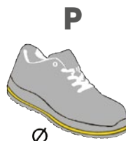
INSERTO METALLICO RESISTENTE ALLA PERFORAZIONE: CHIODO CONICO Ø=4,5 mm
